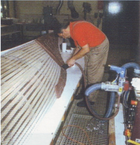
Hamburgische Schiffbauversuchsanstalt; Alternative im Bootsbau: Korpus aus FORMETAL YPSILON & Sika Kunstharz
