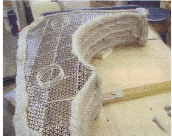
Leichtbauteil mit FORMETAL YPSILON und Alufix Modellbausystem, gecouvert mit selbsthärtender Kunststoffmasse © Horst WITTE Gerätebau
