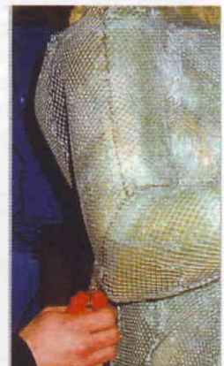
Um FORMETAL VARIUS von der Originalskulptur herunterzunehmen, sind unter Umständen einzelne Partien mit einer Universalschere abzutrennen.
